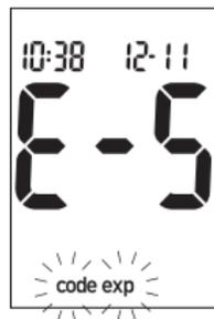
La puce d'étalonnage provient d'un lot de bandelettes-test qui est périmé. Vérifiez que le code de la puce d'étalonnage est identique à celui imprimé sur le contenant de bandelettes-test. Vérifiez que l'heure et la date du glycomètre sont correctes.
