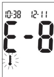
La température est supérieure ou inférieure aux températures préconisées pour l'utilisation du glycomètre. Consultez la notice d'utilisation des bandelettes-test pour des informations relatives aux conditions de fonctionnement du système. Déplacez-vous dans un endroit de conditions appropriées, attendez cinq minutes et recommencez l'analyse. N'essayez pas d'accélérer le réchauffement ou le refroidissement du glycomètre.
