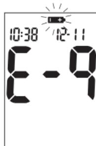
La pile est presque à plat. Remplacez la pile maintenant.
