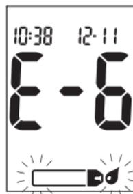
L'aspiration du sang ou de la solution de contrôle par la bandelette-test s'est produite avant que ne s'affiche le symbole de la goutte clignotante à l'écran. Éliminez la bandelette-test et recommencez l'analyse.
