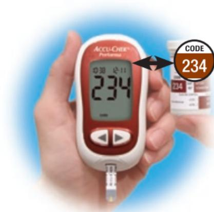
1. Insérez la bandelette-test dans le glycomètre dans le sens des flèches. Le glycomètre s'allume.
