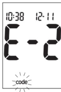
Ce n'est pas la bonne puce d'étalonnage. Éteignez le glycomètre et insérez une nouvelle puce d'étalonnage. Si le problème persiste, contactez Roche.
