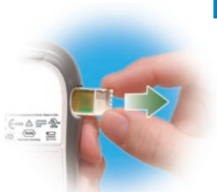
3. Retirez l'ancienne puce d'étalonnage (s'il y en a déjà une dans le glycomètre) et éliminez-la.
