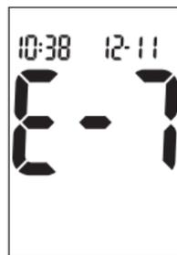
Une défaillance électronique s'est produite ou, ce qui est rare, une bandelette-test usagée a été retirée du glycomètre et réinsérée. Éteignez le glycomètre puis rallumez-le ou retirez la pile pendant 20 secondes et réinstallez-la. Effectuez une analyse de glycémie ou un test de contrôle. Si le problème persiste, contactez Roche.
