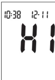
La glycémie peut être supérieure à l'intervalle d'analyse du système.
