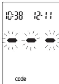
Le glycomètre n'est pas étalonné ou la puce d'étalonnage n'a pas été insérée. Éteignez le glycomètre et procédez à un nouvel étalonnage.
