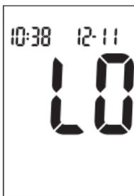
La glycémie peut être inférieure à l'intervalle d'analyse du système.
