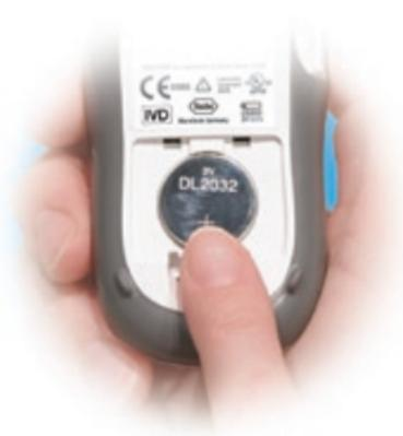
1. Poussez l'onglet dans le sens de la flèche pour soulever le couvercle de la pile situé à l'arrière du glycomètre. Retirez la pile usagée.
