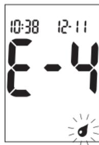
La bandelette-test n'a pas aspiré suffisamment de sang ou de solution de contrôle pour que l'analyse soit possible ou bien l'aspiration suffisante de sang ou de solution de contrôle s'est produite après le démarrage de l'analyse. Éliminez la bandelette-test et recommencez l'analyse.
